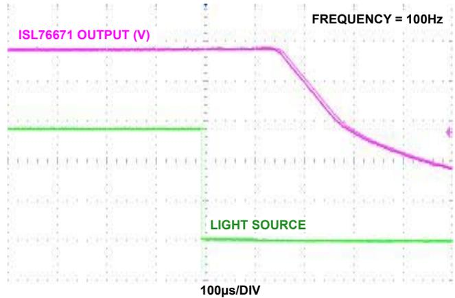
FIGURE 19. DELAY TIME vs LUX CHANGE TO 0 LUX
