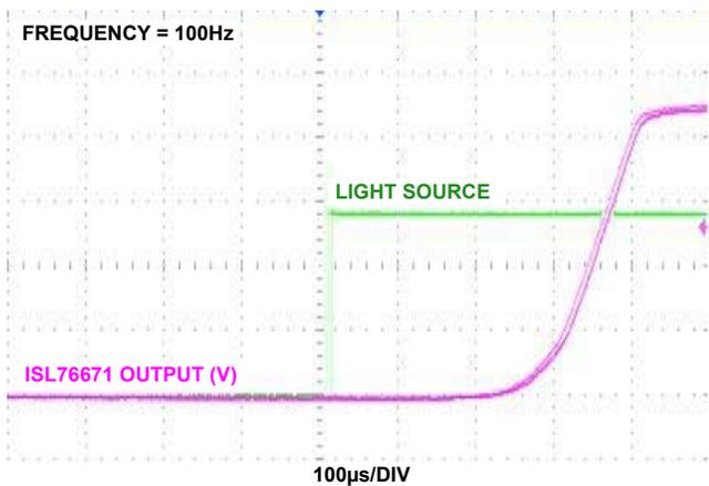
FIGURE 18. DELAY TIME vs LUX CHANGE FROM 0 LUX
